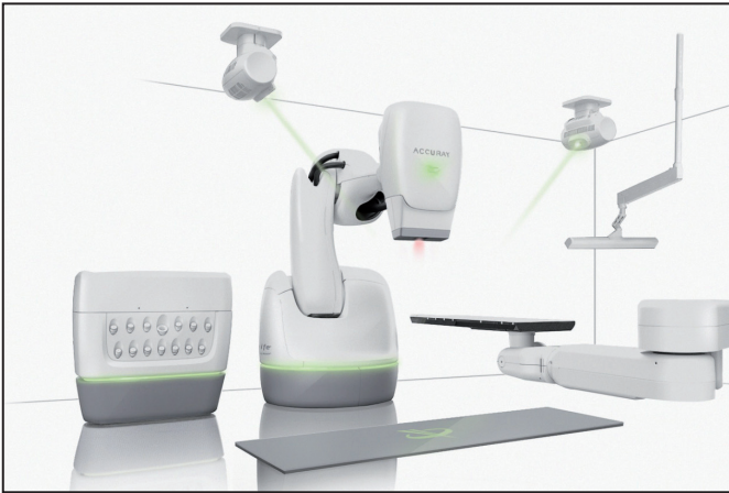
Abb. 1. CyberKnife System. Das Bestrahlungsgerät hängt an einem Roboterarm und wird dadurch extrem genau gesteuert. Durch Röntgenröhren an der Decke und Infrarotsensoren werden die Lagerung des Patienten und Bewegungen während der Behandlung kontinuierlich überwacht, und ggf. kann der Roboter die Bestrahlung sofort korrigieren, © O. Blanck
